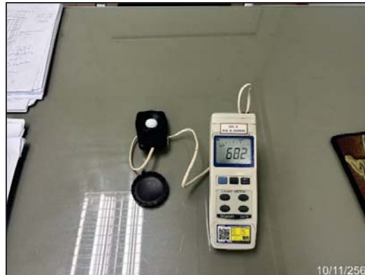
รูปที่ 3.8 การตรวจวัดความเข้มของแสงสว่างในพื้นที่ปฏิบัติงาน
